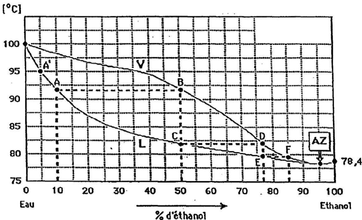
Le diagramme montre cependant que la courbe de vapeur (V) rejoint celle du liquide (L) pour une concentration en éthanol de 95,6%. Quand ce point, nommé azéotrope (AZ) est atteint, le liquide et sa vapeur ont la même composition et il devient impossible de concentrer d'avantage l'alcool par de nouvelles distillations.
