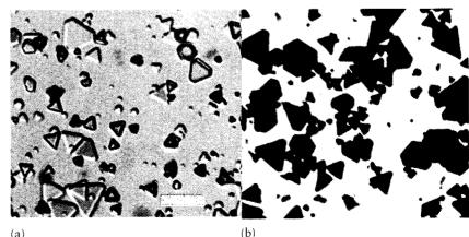
Microphotographie de cristaux d'halogénure d'argent dans une émulsion photographique avant (a) et après (b) le développement. La barre bleue représente 1 mm.
